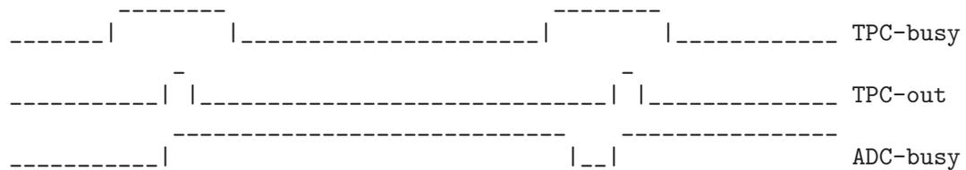
Unter den gegebenen Bedingungen: häufige Totzeit durch den TPC und seltene Totzeit durch den ADC, sollte der Fehler jedoch gering sein. Bei Messungen mit dem LIC-Aufbau wird die Totzeit über das LIC-Interface gemessen, und die Lifetime-Kennung ist entsprechend anzugeben.
